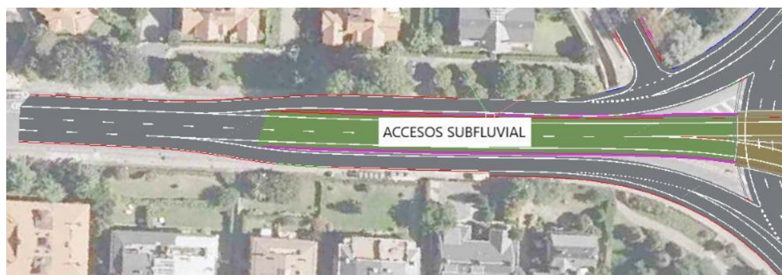
Figura 37: Conexión carretera Asúa-Subfluvial
